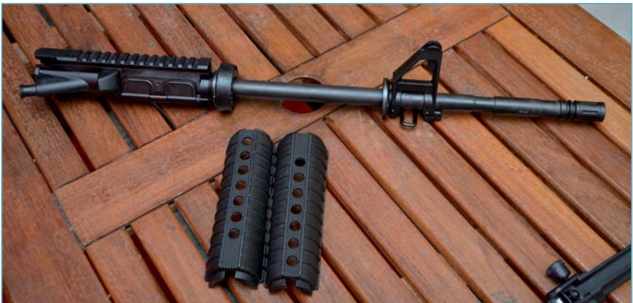
▲ L' upper receiver , completo della canna. Rispetto all'originale in .223 Remington manca ovviamente il sistema di presa dei gas
