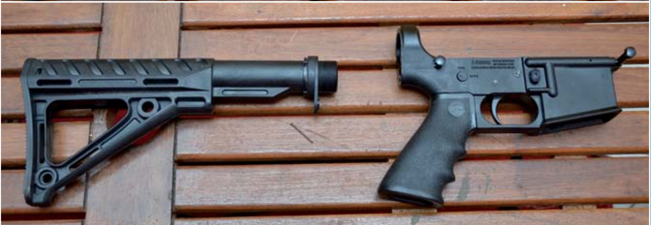
▲ Lo smontaggio del calcio e dell'impugnatura
