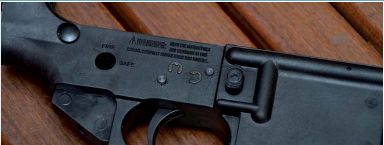
▲ I perni dello scatto sono bloccati da questi due seeger che ne impediscono la fuoriuscita nelle cadenze di fuoco veloci
