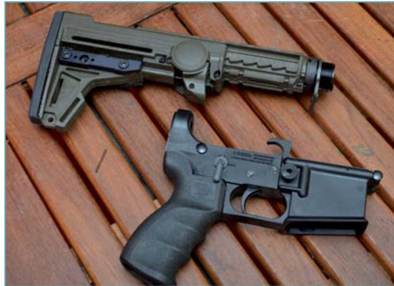
▲ L'impugnatura nella parte posteriore non si accoppia perfettamente con il profilo del *lower*. Il calcio prescelto è completo di tubo regolabile che si dimostra anch'esso del tutto compatibile
