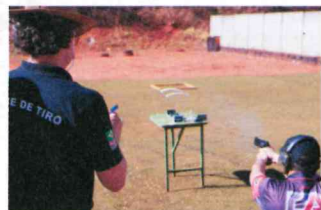
Começamos a parte prática por medir a velocidade, em cronógrafo. Disponíveis, munição CBC Treina, também munição de recarga, com projétil cônico de chumbo de 160 gr e 3,9 gr de pólvora CBC 216. Com a munição comercial, média de 844 fps (257 m/s), com diferença entre extremos de 2%. Com a de recarga, média de 863 fps (263 m/s), com diferença entre extremos de 5%.
