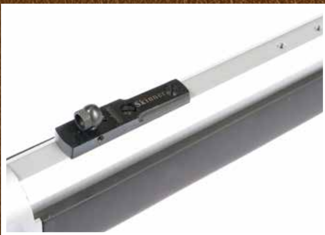
Paksu piippu on osittain kahdeksankulmainen ja sen päällä on valmiit kierrereivät kiikarinjalolle. Nyt takatähtäimenä on erikoinen Skinner, jossa hahlolevyn tilalla on suurireikäinen diopteri. Tällä on riittävässä valaistuksessa helppo ampua tarkasti ja suhteellisen nopeaan.
