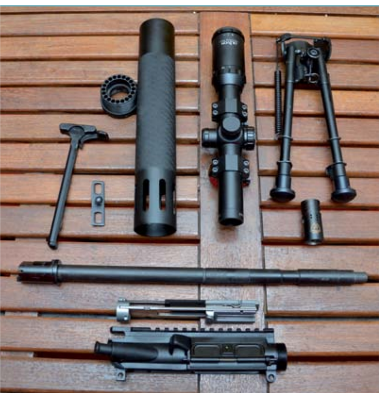
▲ Per provare l'effettiva compatibilità del Chiappa con i componenti AR-15 proviamo a installare un kit per IPSC Open composto da un copricanna flottante con boccola maggiorata, un calcio regolabile, un bipiede, una leva di armamento con orecchia maggiorata, un compensatore, uno sgancio maggiorato del caricatore e un'ottica variabile
