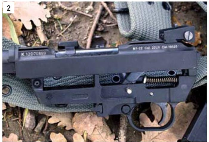
**1.** Il gruppo di scatto, in polimero, riprende la forma e il sistema d'aggancio dell'originale. La struttura interna è, però, semplificata. In evidenza anche la sicura a levetta rotante e il pulsante di sgancio caricatore.
